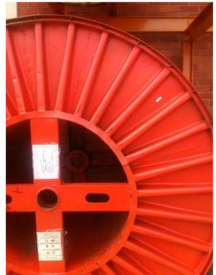
新加坡制造技术研究所开发的基于安卓应用程序和基于web的位置数据库可以追踪并定位所有安装了标签的电缆卷筒。当工作人员发现某个卷筒被移动了，他只要使用带有ARETE POP RFID读写插件的安卓系统智能手机扫描位于该区域的标签，RFID就会在系统中自动更新代表该电缆卷筒的位置信息，整个过程只要几秒钟，相比过去长达半个小时的寻找时间，Keystone Cable的管理效率大大提高了。
